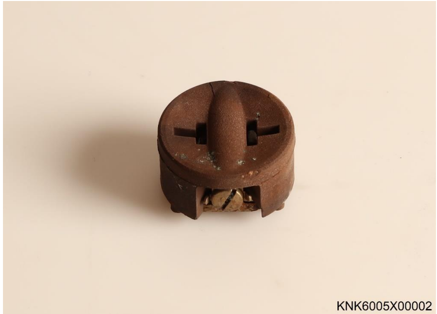
På fotoet til venstre ses en Hubbell T-stikkontakt. KNK6005X00002, har formentlig set ud på samme måde da den var i funktion på BW3.
